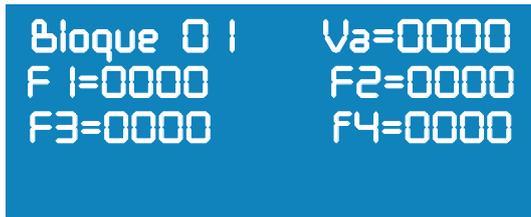
In questo dettaglio si possono vedere i volumi, sia dell'acqua sia dei fertilizzanti, che sono stati utilizzati per il blocco selezionato.
